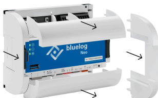
Retirer les quatre couvercles de protection
